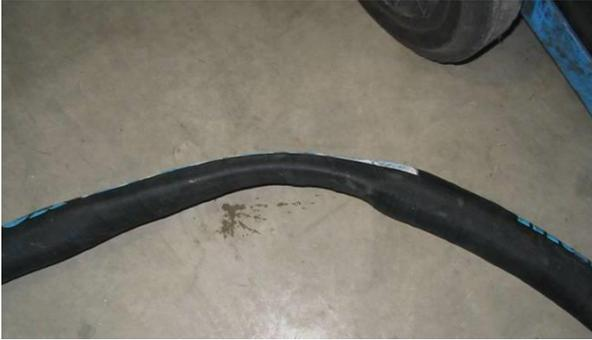
Schlauchleitungen haben immer einen spezifischen Biegeradius. Wenn dieser unterschritten wird, kann die Schlauchleitung knicken. In einem solchen Fall kann es zur plastischen Verformung einer der Schlauchschichten kommen. Häufiger aber werden Schlauchleitungen einfach überfahren. In beiden Fällen kann die Druckfestigkeit der Schlauchleitung nicht mehr gewährleistet werden.
