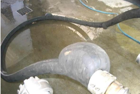
Eine Schlauchleitung besteht fast ausnahmslos aus mehreren Lagen bzw. Schichten. Versagt eine der Komponenten oder ist die Haftung zwischen den Schichten nicht mehr ausreichend, kann das Medium zwischen die Schichten geraten. In einem solchen Fall können gefährliche Druckblasen entstehen, welche nicht geöffnet werden sollten. Jene Leitungen müssen ausgewechselt werden.
