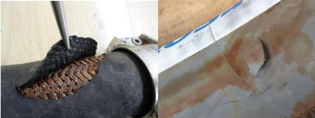
Kleine Beschädigungen in der Gummidecke können ein Hinweis auf eine nicht mehr vorhandene Lagenhaftung sein. Auch eine Beschädigung des darunterliegenden Druckträgers kann nicht ausgeschlossen werden. Selbst wenn der Druckträger noch unbeschadet aussieht, sind bereits Mikroverletzungen der Fäden sehr wahrscheinlich. Ohne die schützende Decke ist der Druckträger allen äußeren Einflüssen ausgesetzt. Ein sicherer Betrieb ist nicht mehr möglich, diese Leitungen gehören aussortiert.
