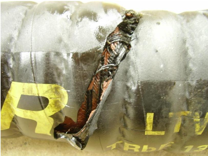
Schlauchleitungen, die bei der Wiederholungsprüfung platzen, stellen eine kontrollierte Gefahr dar. Die Prüfung sollte immer unter Sicherheitsaspekten mit entsprechenden Maßnahmen erfolgen.
